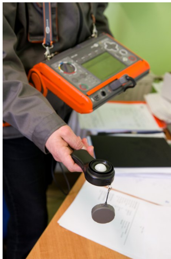
foto. Pomiar natężenia oświetlenia
